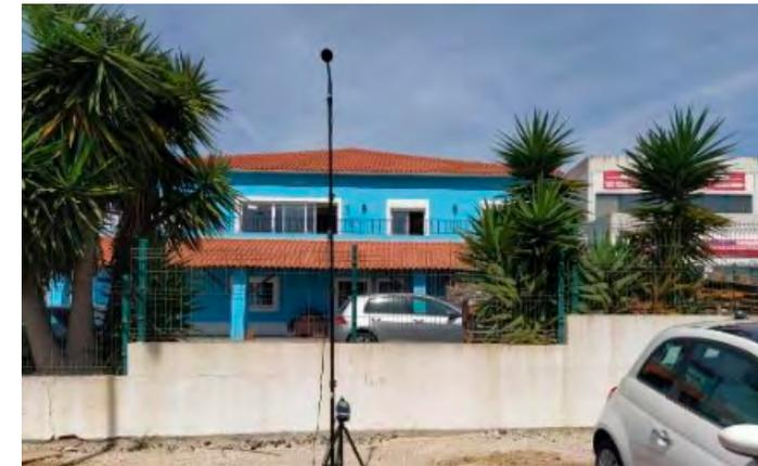
Surveillance des vibrations causées par le démontage de massifs rocheux dans les travaux ferroviaires de la ligne de la Beira Alta et la 3<sup>e</sup> phase de l'agrandissement de la jetée Est du Port de Sines au Portugal.
